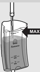
Regelmæssig afkalkning forlænger kaffemaskinenes levetid og garanterer optimal kaffebrygning i meget lang tid. Bruges maskinen gennemsnitligt 2 gange dagligt, bør den afkalkes 1 gang om måneden.
